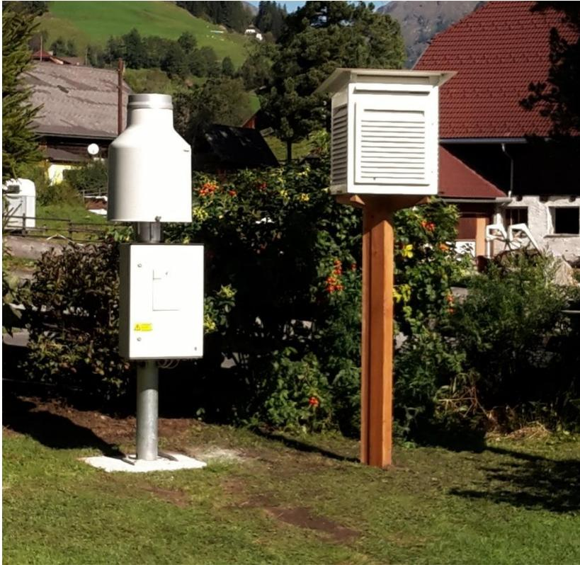
Im Anhang ein Foto einer vergleichbaren automatischen Messstationen in Lessach. Gemessen werden die Parameter Niederschlag, Lufttemperatur, Luftfeuchtigkeit und eventuell Schneehöhe und Wind.
